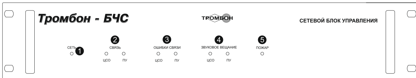
Рис. 1. Блок «Тромбон – БЧС», вид на переднюю панель.
