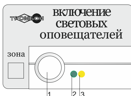
Рис. 3 Эскиз удалённого выключателя светового оповещения «Тромбон – ВСО»
