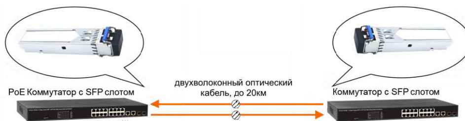
Рисунок 5 - Схема подключения для «комплекта SFP модулей»
